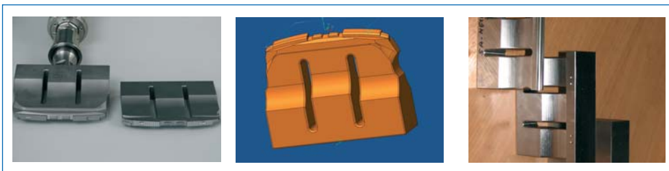
Vergleich: Auf dem linken Bild sieht man zwei Sonotroden, links (und auf dem mittleren Visi-Screenshot) die mit Visi gefertigte, die rechte stammt aus der Zeit vor dem Einsatz des CAM-Systems. Das Bild rechts zeigt die drei Stufen, in denen eine Sonotrode entsteht. Hinten das Rohteil, in der Mitte der Grundkörper und vorne die mit Visi gefertigte Kontur.
