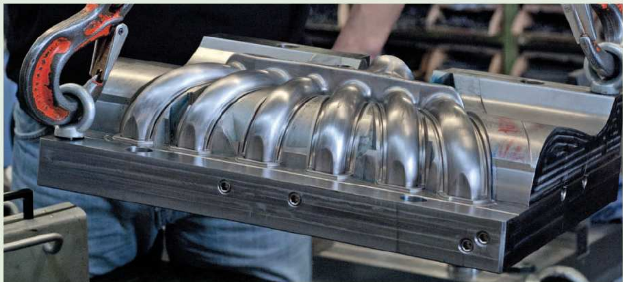
Wie von selbst: Bei der NC-Programmierung mit Visi Compass entstehen per Feature-Erkennung 2- und 2,5-Achs-Programme für Bohrungen oder Ausfräsungen quasi automatisch.
