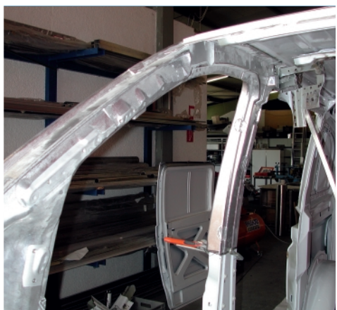
Eingebaut: Die A- und B-Säule von innen betrachtet, rechts oben mit Kunststoff-Abdeckung.
