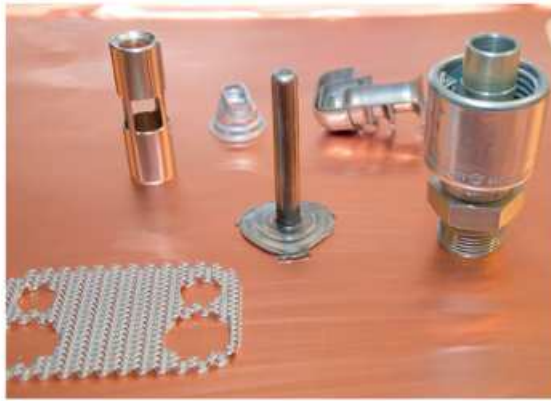
Der Thermostatschieber (links hinten im Bild) war zwar einfach zu simulieren, doch erst eine neue Drehmaschine konnte die Simulations-Ergebnisse auch umsetzen. (Bild: Stotz)
