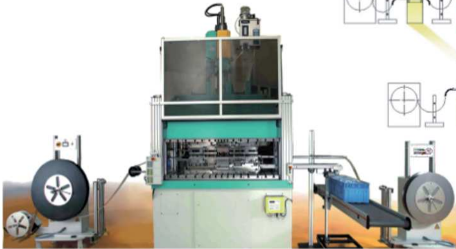
Schematischer Vergleich des Reel-to-Reel Verfahrens (im Bild a oben) mit dem Folgeverbundspritzen bei Kummer (im Bild a unten) sowie die Anlagenkonstellation in b. Kummer hat beim Folgeverbundspritzen drei Fertigungsschritte in einer Maschine beziehungsweise Anlage vereint.
