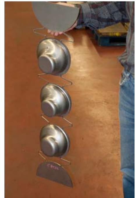
Von der Werkzeugkonstruktion bis zur Ausprobe: Teststreifen von im Folgeverbund aus Edelstahl tiefgezogenen Trichteranteilen aus Edelstahl, die in einem Schalldämpfer verbaut werden.
