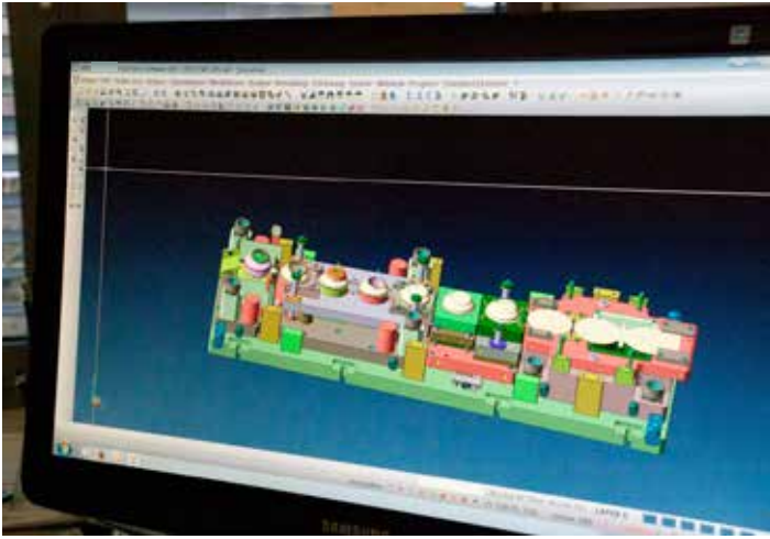
VISI zählt zu den ganz wenigen 3D-CAD-Lösungen am Markt, die über spezielle Module für Stanz- und Umformwerkzeuge verfügt. Hier die Unterseite eines mit VISI Progress aufgebauten modularen Folgeverbundwerkzeugs.
