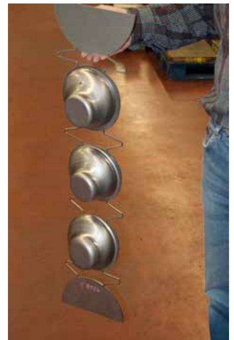
Von der Werkzeugkonstruktion bis zur Ausprobe: Teststreifen von im Folgeverbund aus Edelstahl tiefgezogenen Trichterterteile aus Edelstahl, die in einem Schalldämpfer verbaut werden.
