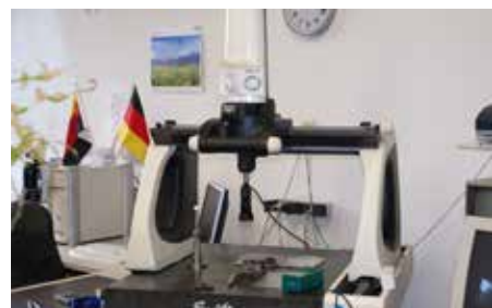
Auf Wunsch wird jedes erodierte Werkstück 3D-gemessen und ein Messprotokoll mitgeliefert.
