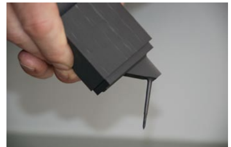
Hohe Präzision: Zeitgleich mit der Inbetriebnahme der neuen Fertigungszelle wurden in Kronberg die Elektroden überwiegend auf Grafit umgestellt
