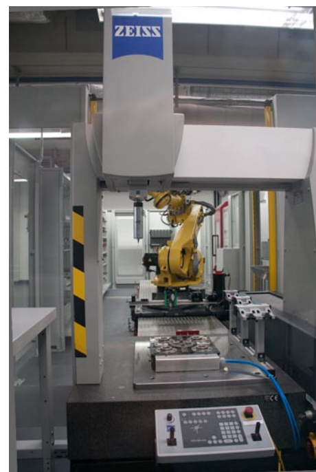
Automatischer Soll-Ist-Vergleich der Elektrodenkontur gegen das CAD-Modell: Messplatz mit Koordinatenmessmaschine Zeiss Eclipse.
