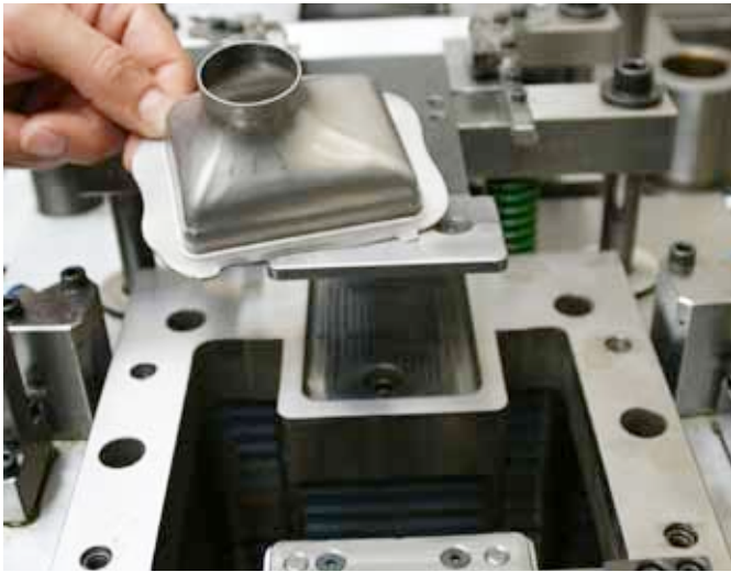
Der obere Teil des Verbundziehwerkzeuges mit dem Bauteil – noch unbeschnitten (Bild: Stotz)
